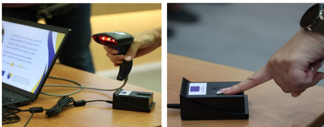
Slika 1. Set opreme za biračko mjesto: prijenosno računalo, bar kod skener za dokumente, skener otisaka prstiju
